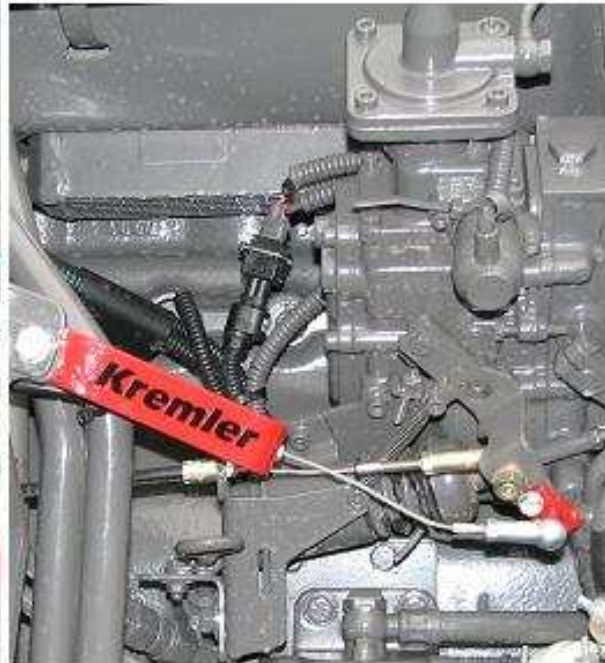
Baudenzug vom Stellmotor zur Einspritzpumpe
